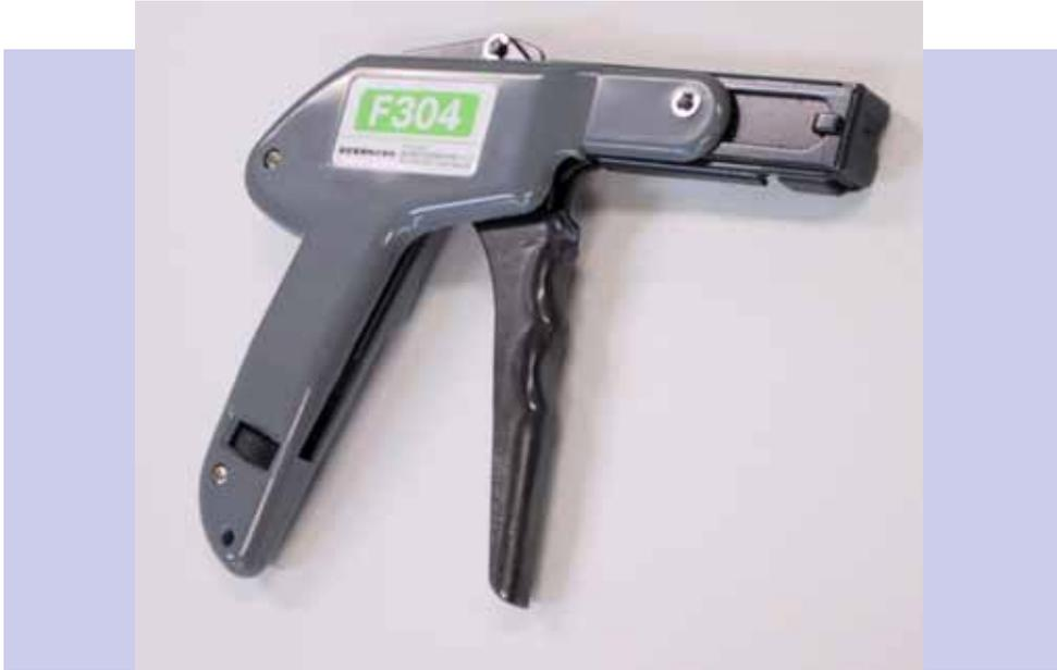
軽量で手軽に扱えるとともに、切断時の反動もなく、軽い握力で作業できます。ケーブルタイの寸法に合わせて、あらかじめ締め付け強度が設定可能です。ケーブルタイをワイヤー束と直角にカットでき、切り口にもバリを残さず、後続作業も安全です。
